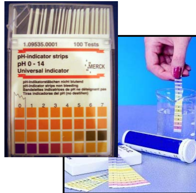
Varillas de pH (in situ)
